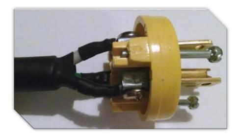
Armado de NEMA 5 -15P con cable uso rudo 3x12 AWG con thermofit
